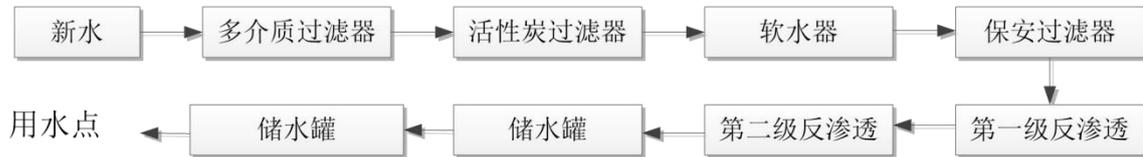
图 3.5-8 验收阶段纯水处理工艺流程图
